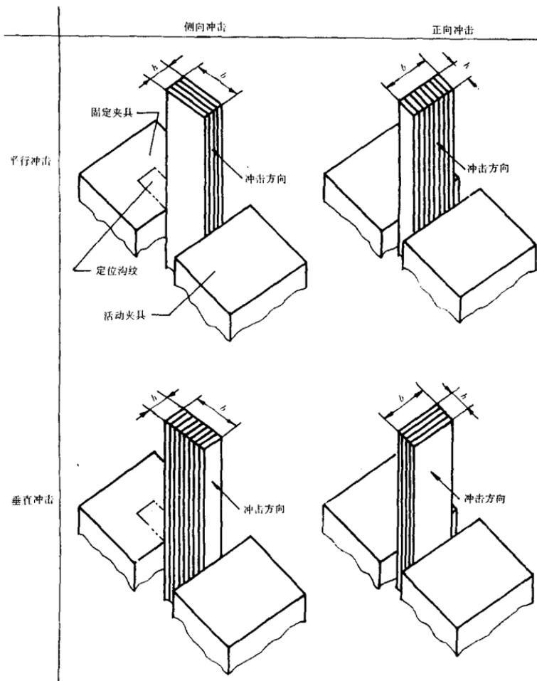
冲击方向对试样厚度( $h$ )和宽度( $b$ )分为侧向冲击和正向冲击;对层压平面分为平行冲击和垂直冲击。
